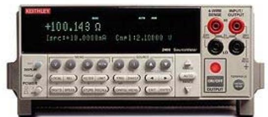
一個低雜訊、高重複性及高阻抗的 5 位半電錶，因此一個單一通道的直流參數量測儀器就此誕生。在操作方面，電源電錶可以當作一個電壓源。電流源或者電壓錶及電流錶甚至一個歐姆計來使用，它提供了單一電源供應器或量測錶所沒有的優點，例如：半機架大小的儀器節省了許多空間，它也減少了測試平台的開發設定和維護，降低使用者系統架設的花費，除此之外，電源電錶藉由減少許多儀器的同步和接線問題簡化了測試流程，所有六個型號的電源電錶系列皆可以做大範圍的直流特性量測，包括在特定電流電壓下的電阻量測，崩潰電壓，漏電流，絕緣組抗及電性特性分析。
